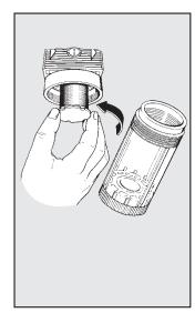
Per pulire o sostituire l'inserto svitare lo schermo del gruppo centrifugazione. Per svitare la tazza usare chiave a compasso
